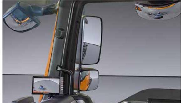
Die Video-Abbiegehilfe (VTA) ist ein Standalone-System für Fahrzeuge, die bisher über keine Abbiegeassistenzsysteme verfügen. Verfügt das Fahrzeug schon über eine serienmäßig verbaute Abbiegehilfe bietet sich das Seitenkammersystem (SCS) zur Nachrüstung an.
