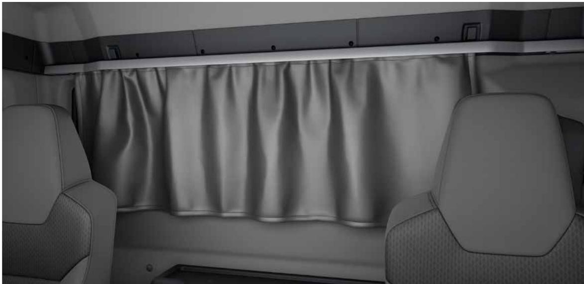
Der Vorhang für das Fenster in der Rückwand des Fahrerhauses ist aus blickdichtem Stoff und bietet einen wirksamen Schutz vor Wärme sowie Licht- und Sonneneinstrahlung. Während der Schlaf- oder Ruhepausen kann das Fahrerhaus verdunkelt und dadurch der Komfort und die Erholung deutlich gesteigert werden. Der Vorhang kann zum Waschen und Reinigen einfach entfernt werden.
